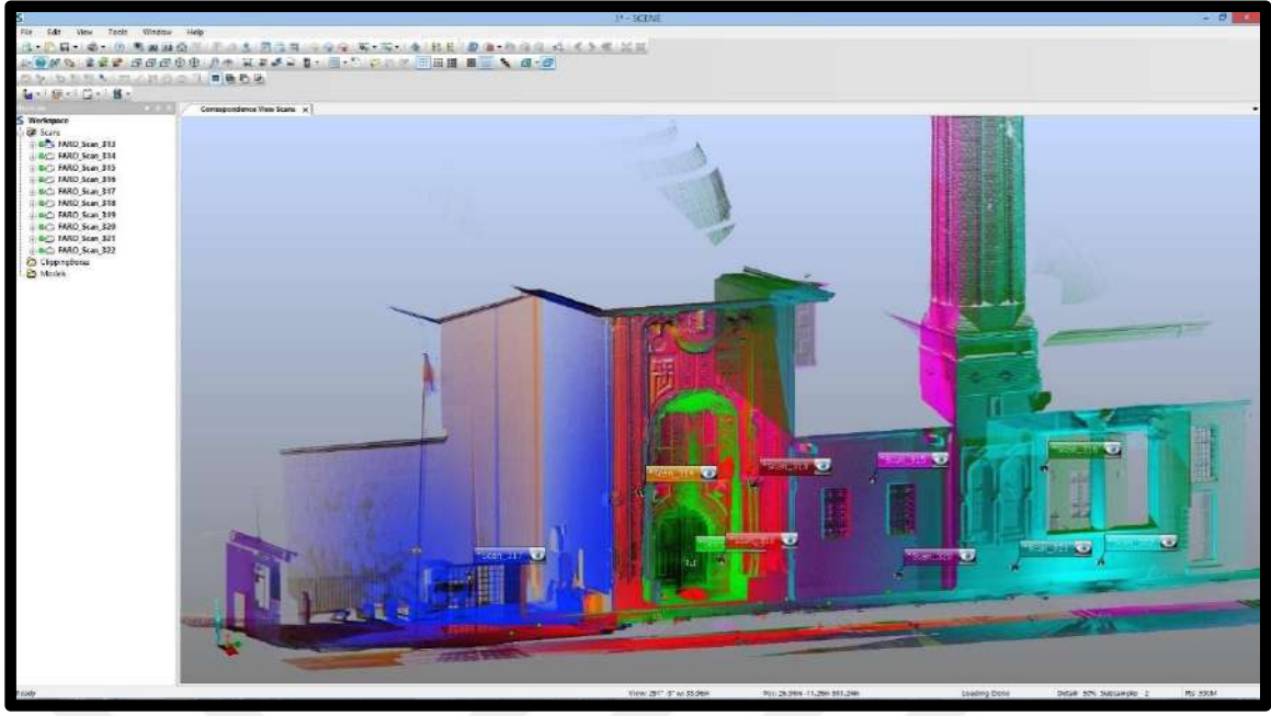
Şekil 4.3. Oturumları Renklendirilmiş Nokta Bulutu
