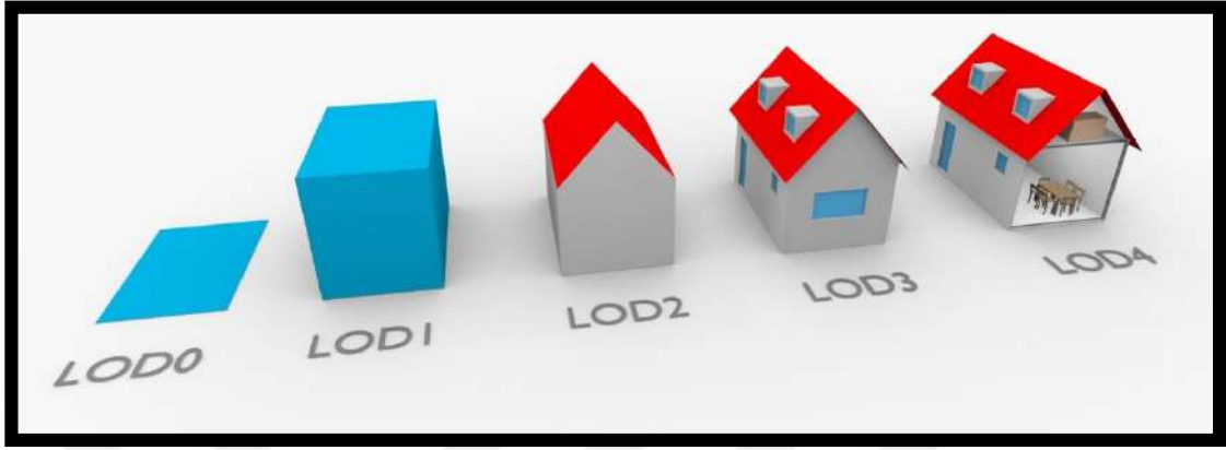
Şekil 3.1. CityGML'deki ayrıntı düzeyleri
