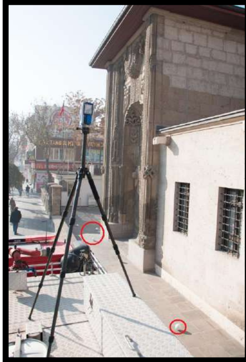
Şekil 5.8. Lazer Tarayıcı ve Özel Yansıtıcı Küre Hedefler.
