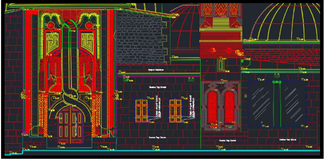
Şekil 5.21. Nokta Bulutundan Çizilen Ön Cephe
