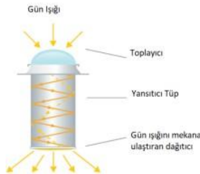
Şekil 3.12. Işık tüpü çalışma prensibi (Sevinç ve Altın, 2021, s.152)
