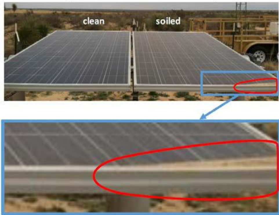
Őekil 3.9. EŐ dađılım gstermeyen bir toz kirliliđi (Panelin sađ alt kŐesinde toz birikmesi gerekleŐmiŐ) [25]
