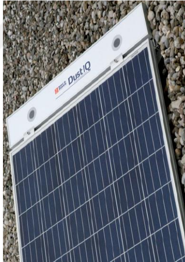
Şekil 3.12. Kipp & Zonen firmasına ait optik sensörler yardımıyla kirlilik miktarını ölçtüğü sensörün görseli [27]
