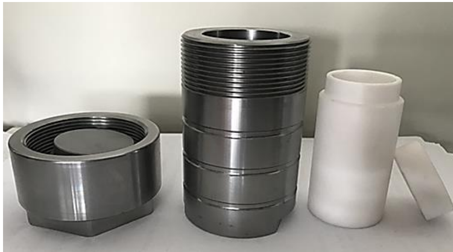
Şekil 2.4 Çelik gömlekli otoklav sistemi ve teflon haznesi
