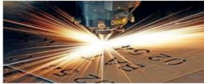
Şekil 1.7. Neodimyum Kullanıldığı Lazer kesme sistemi [24]
