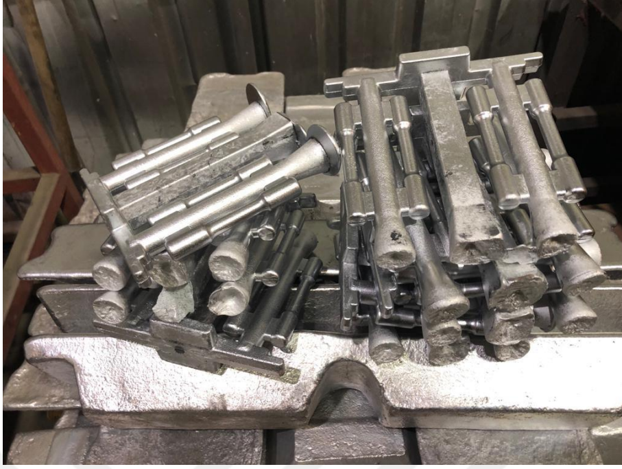
Şekil 3.3. Dökümü yapılan A357 Al alaşımı standart deney numuneleri
