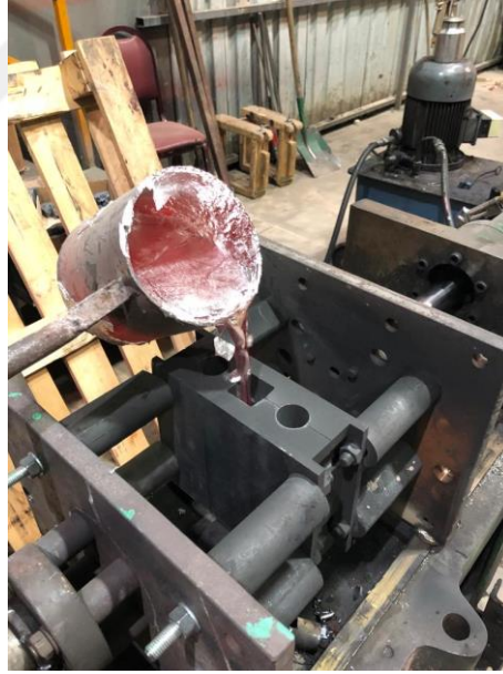
Şekil 3.2. A357 Al alaşımı standart numune döküm işlemi
