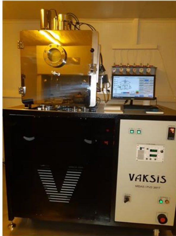
Şekil 3.4. VAKSİS MİDAS 3M1T manyetik alan sıçratma sistemi.
