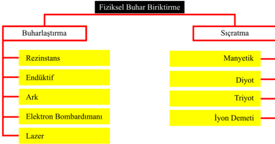
Şekil 3.2. Fiziksel buhar biriktirme yöntemleri (Sönmezoğlu ve ark., 2012).
