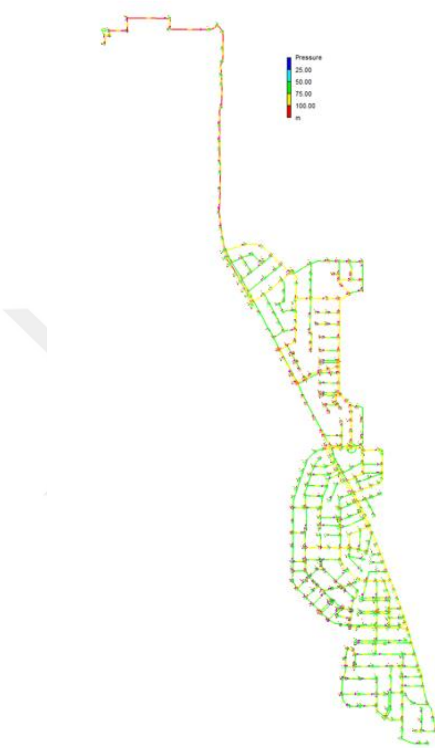
Şekil 4.9. MsSu hidrolik model basınç haritası
