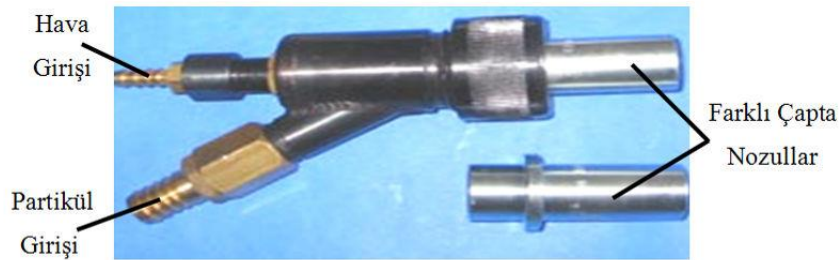
Şekil 3.12 Deney düzeneğinde kullanılan kumlama tabancasından bir kesit (Bağcı, 2010).
