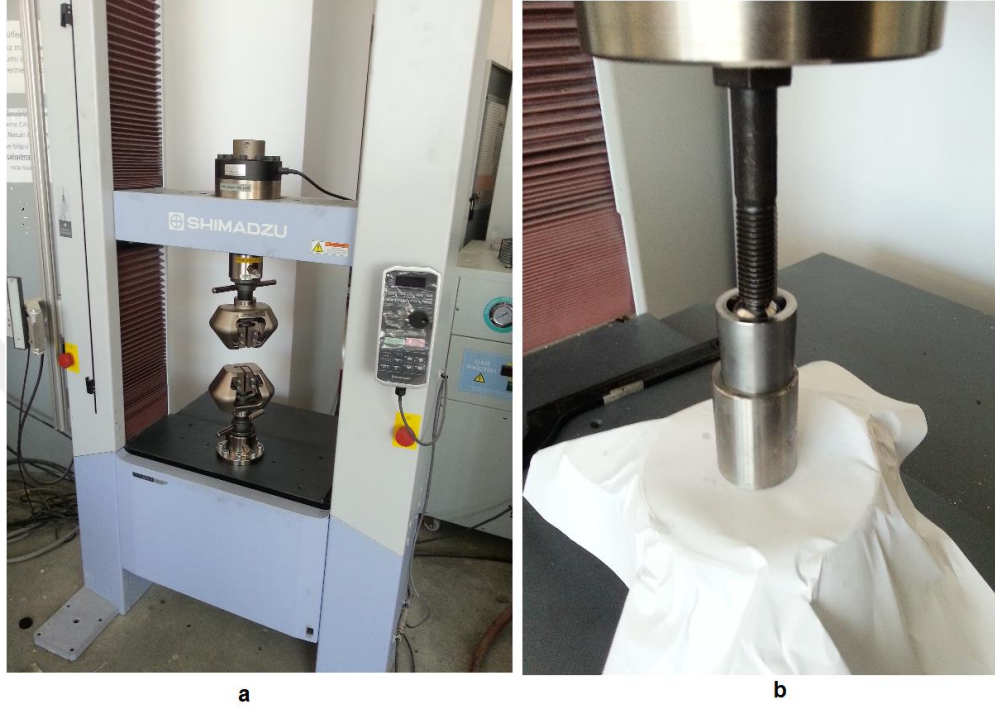
Şekil 3.4 a) Shimadzu AG-XPlus çekme testi makinesi, b) Bilyeleme işleminin uygulanışı
