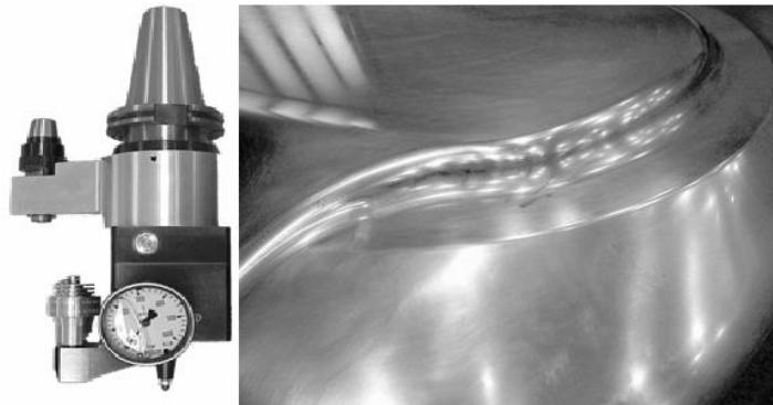
Şekil 2.14 Düz ve serbest formlu yüzeyde parlatma uygulaması (Yamasa, 2006; Has, 2007)
