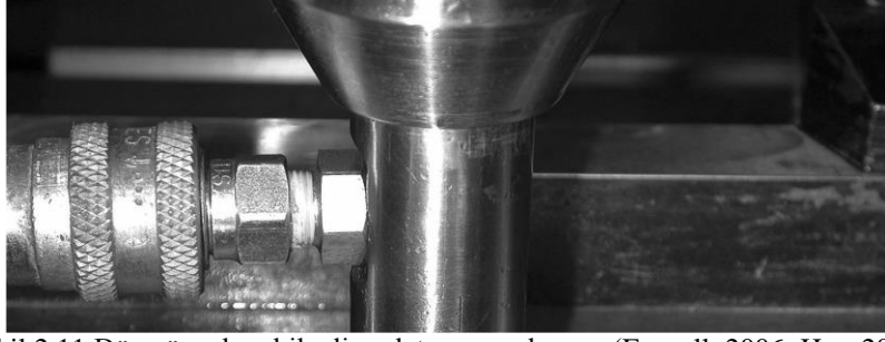
Şekil 2.11 Düz yüzeylere bilyeli parlatma uygulaması (Ecoroll, 2006; Has, 2007)
