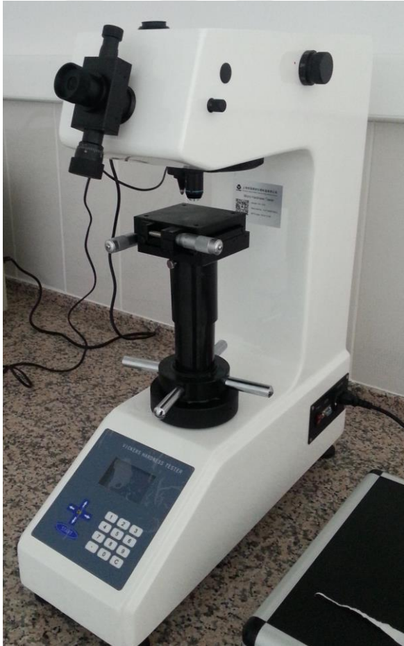
Şekil 3.7 a) Denede kullanılan Vickers sertlik ölçüm cihazı b) Mikrosertlik tarama yönü şablonu
