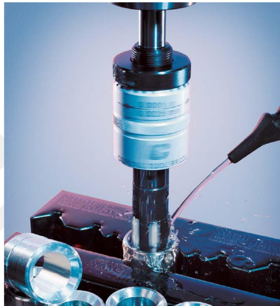
Şekil 2.17 Manuel bir matkap tezgahında makaralı parlatma örneği (Dinçkurt, 2009).
