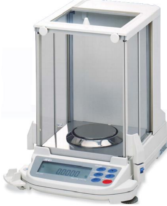
Şekil 3.2. 0,1 mg duyarlılıkla tartım yapan A&D Company (AND) marka GR-200 model elektronik terazi
