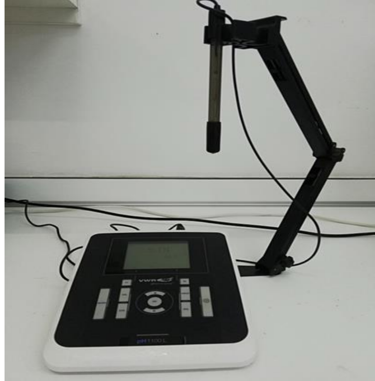
Şekil 3.5. Thermo Scientific Orion 9106BNWP kombine cam pH elektrotu ve onun bağlı bulunduğu VWR Int Geldenaaksebaan 464 B-3001 Leuven pH 1100 L model pH iyon metre
