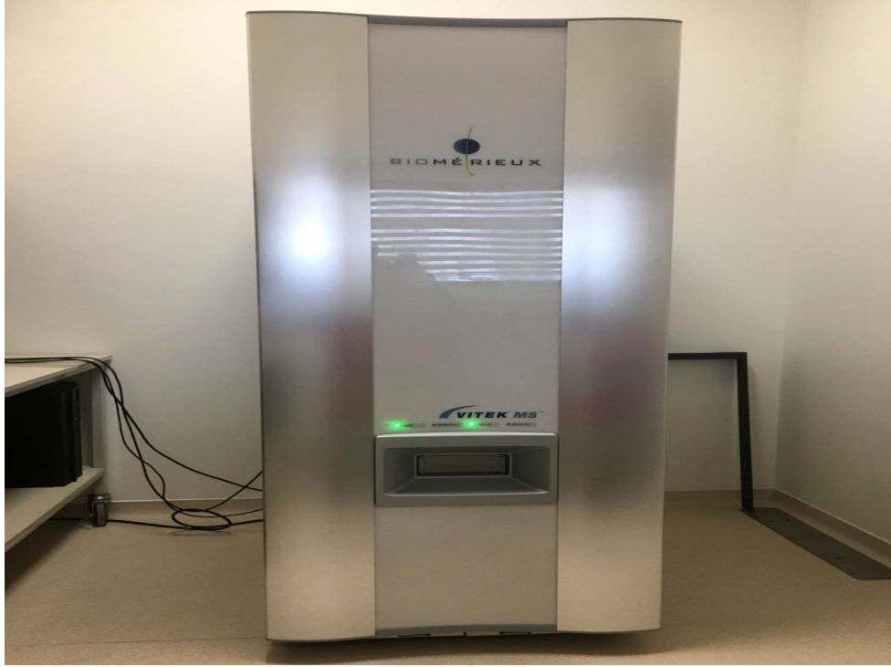
Resim 2: MALDI-TOF MS cihazı
