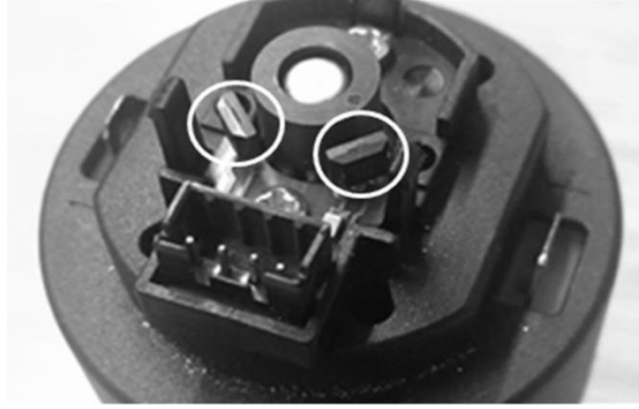
Şekil 2.2. Alan etkili enkoder (Palacin ve Martinez, 2021)
