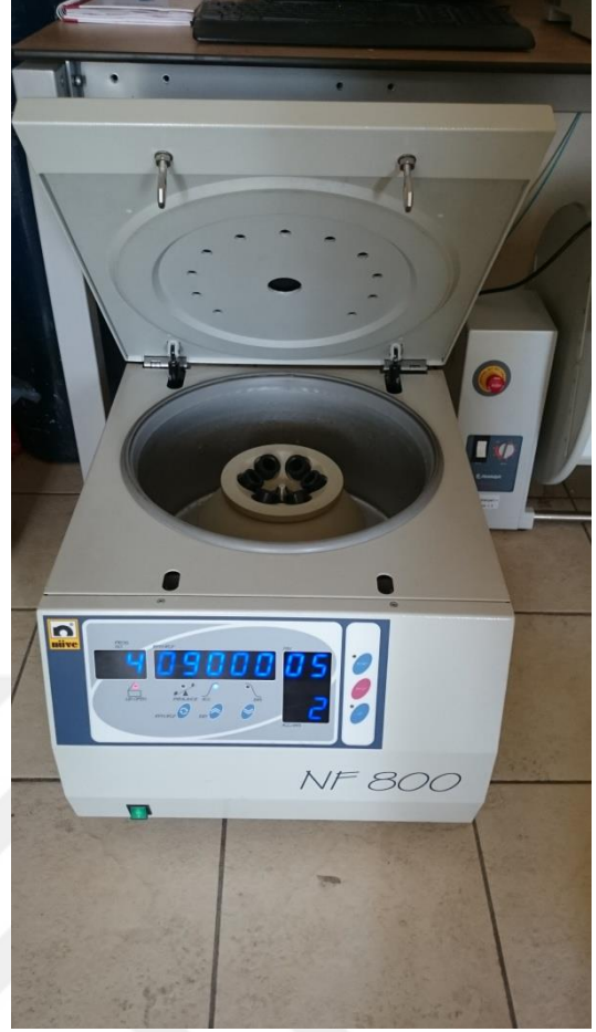
Şekil 3.6. Çamur örneklerinin santrifüj edilmesi
