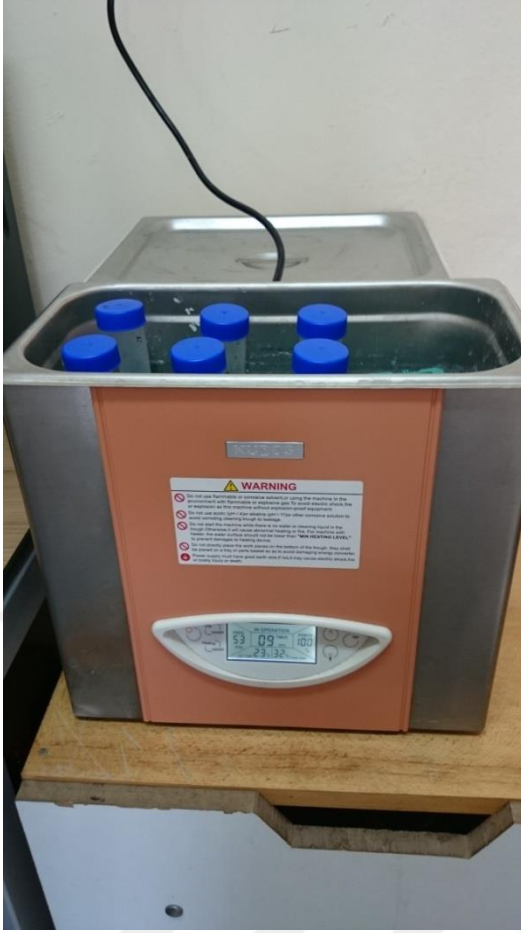
Şekil 3.5. Arıtma çamurlarının ultrasonik ekstraksiyonu
