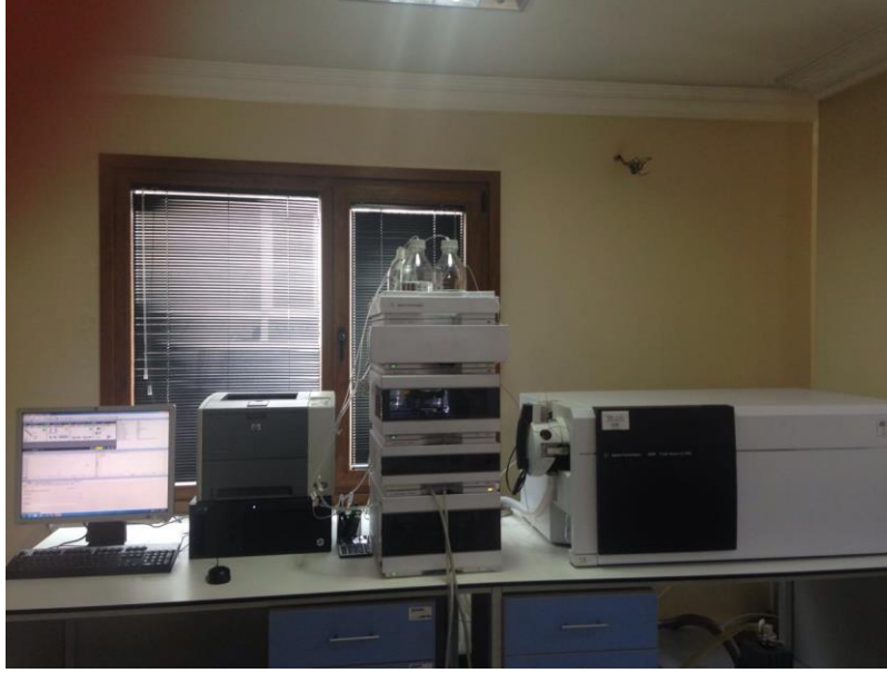
Şekil 3.2. Atıksu ve çamur örneklerinde farmasötik analizlerinin gerçekleştirildiği LC-MS-MS cihazı
