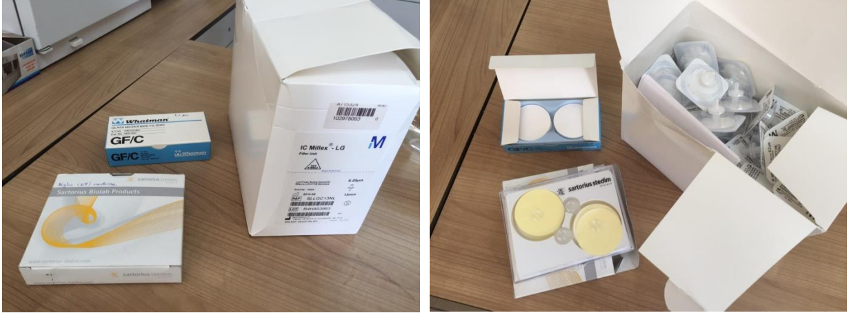
Şekil 3.9. Atıksu örneklerinin ön işleme için kullanılan filtreler
