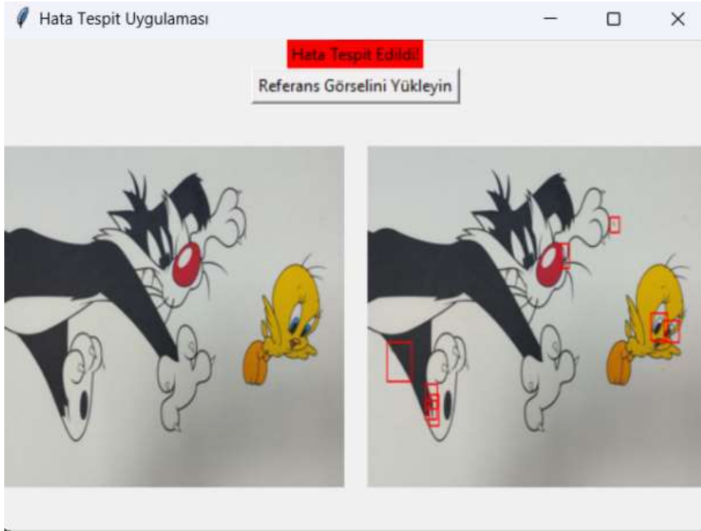
Şekil 4.2. Baskı modelinde hata tespit çalışması (Referans numune- Ürün karşılaştırması)
