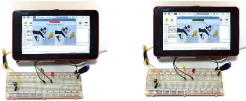
Şekil 3.8. Hatalı ve hatasız üründe LED gösterimi
