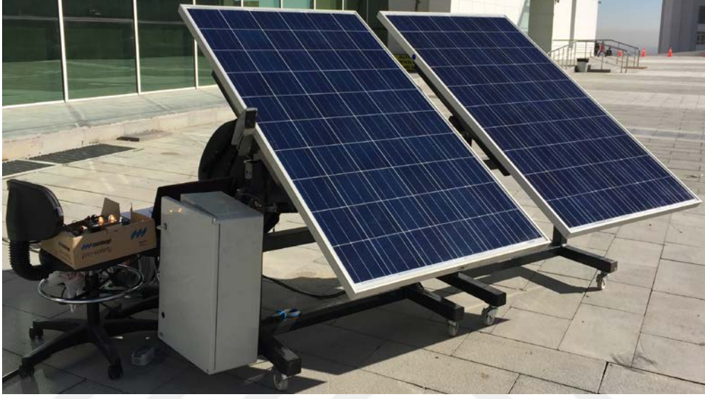
Şekil 4.1. Tek eksen N-S takipli sistem (solda) ve sabit sistem (sağda)
