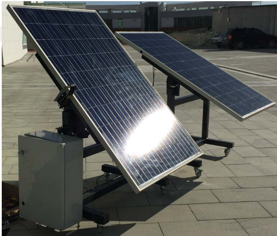
Şekil 3.1. Yan yana yerleştirilen güneş takipli (solda) ve sabit sistemlerin (sağda) deney düzeneği
