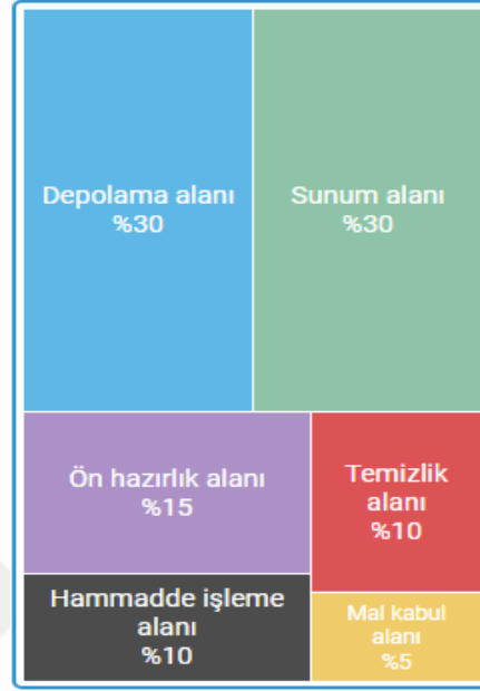
Şekil 3.6. Yiyecek Üretiminde Kullanılan Mekânsal Bölümlerin Snack Mutfağına Dağılımı
