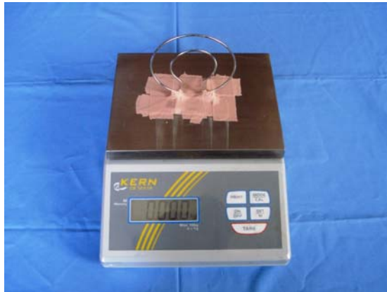
Şekil 16: Kavrama gücü ölçüm düzeneği.
