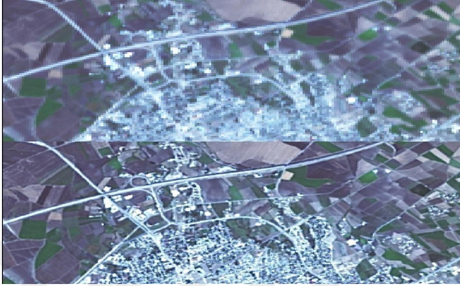
Şekil 4.4. HPF ile Pansharpening uygulanmış görüntü ve 30m çözünürlük multispectral görüntü
