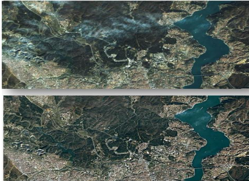
Şekil 3.10. IKONOS görüntüsü üzerinde atmosferik düzeltme ve sis temizleme işlemi (URL-4)
