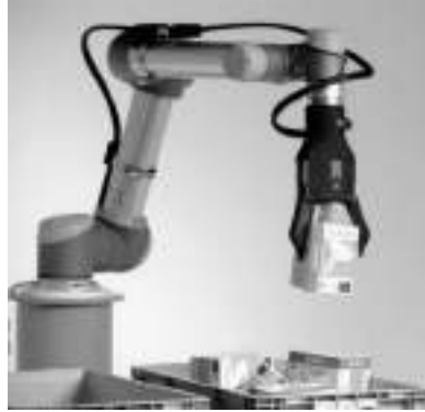
Şekil 3.14. Endüstride kullanılan kısıkaç tipi uç işlevci (“Grasp, Sight, and Picking Evolve In Autonomous Robots”, 2019)
