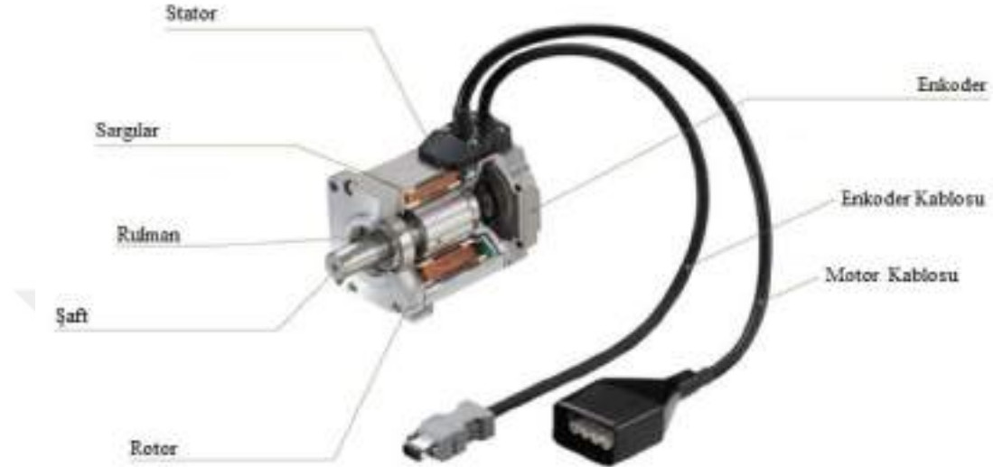
Şekil 3.21. Standart bir servo motor yapısı (“Servo Motor Technology”, t.y.)
