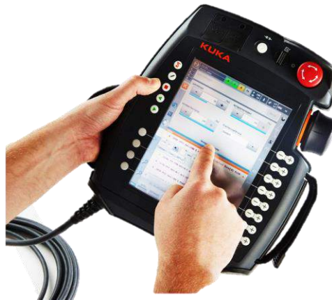
Şekil 3.30. Kontrol ve programlama el cihazı (“KUKA smartPAD-2”, t.y.)
