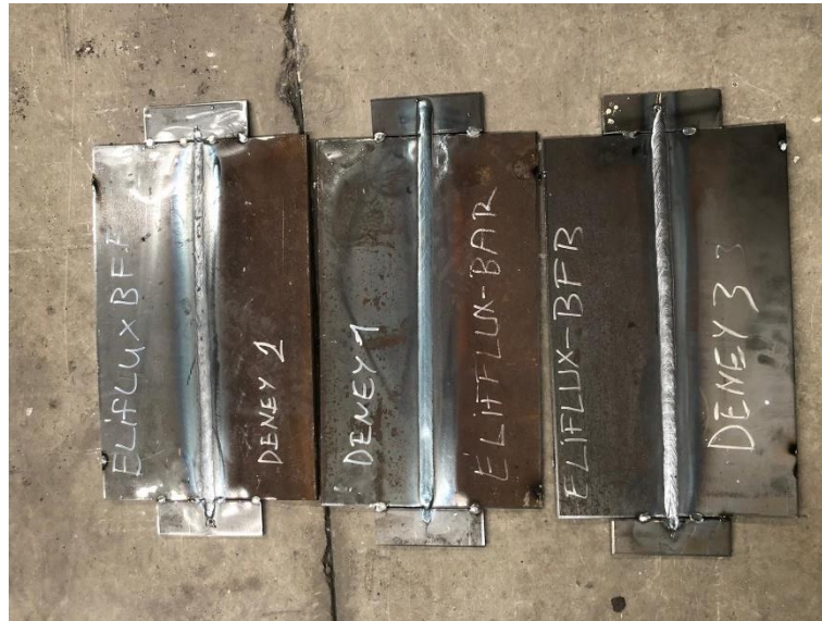
Şekil 6.4. Eliflux Kaynak Tozları ile Yapılmış Kaynak Dikişi Deney Numuneleri
