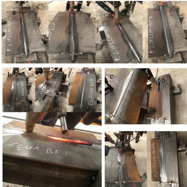
Şekil 6.2. a-BFB tozu ile kayatılan numune b-BFF tozu ile kaynatılan numune c-BAR tozu ile kaynatılan numune
