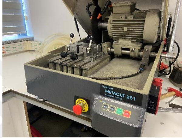
Şekil 6.3. Metkon Metacut 251 Model Kesme Makinesi ile Numune Hazırlama
