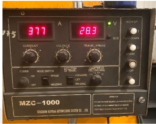
Şekil 6.1. Kamesh Welding tozaltı kaynak robotu kontrol paneli
