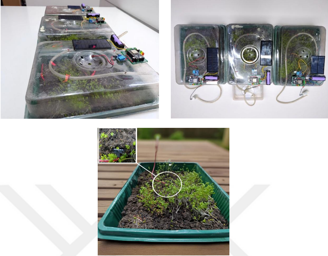
Şekil 4.16. Gerçek donanım üzerinde geliştirilen otonom sulama ünitesi
