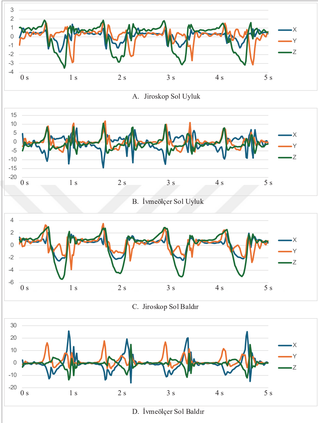
Şekil 4.7. Bir sağlıklı bireyden elde edilen jiroskop ve ivmeölçer verilerinin 5 saniyelik örnekleri: (A) Sol uyluk jiroskop, (B) Sol uyluk ivmeölçer, (C) Sol baldır jiroskop ve (D) Sol baldır ivmeölçer.
