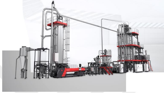
Şekil-2.25.Starlinger RecoStar PET Food Grade Geri Dönüşüm Hattı
