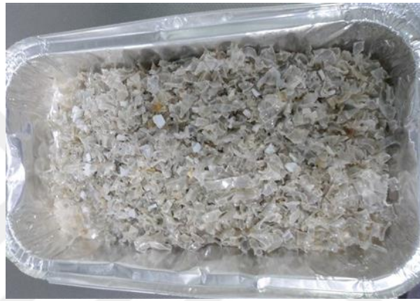
Şekil-E.3 Fırın Testi ile Yanmış PET Flake Numunesi
