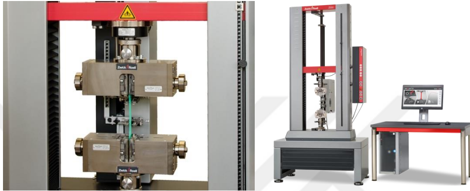
Şekil 3.9. ZwickRoell Z200 Universal Test Cihazı Sağda Çekme Test Aparatı Solda
