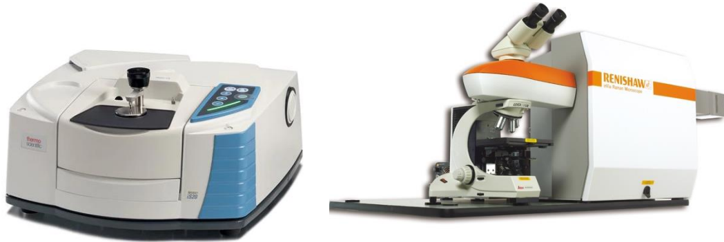
Şekil 3.8. Fourier Dönüşümlü Kızılötesi Spektrometresi (FT-IR Thermo Scientific – Nicolet iS20) (Solda) Renishaw inVia Reflex Konfokal Raman Mikroskobu (Sağda)
