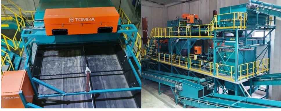
Şekil 2.15. Optik Şişe Ayırıcılar Solda yakından, sağda platform üzerinde
