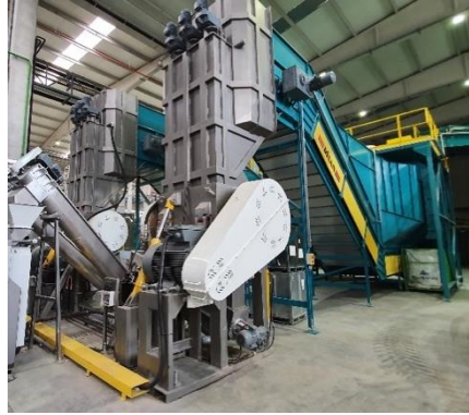
Şekil-2.16.Kırma Makinesi ve onu Besleyen Konveyör Bant
